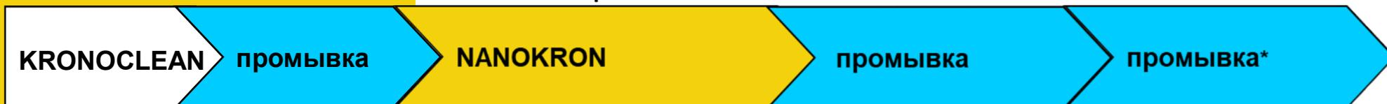
Вариант 4. Схема с предварительным обезжириванием и активацией поверхности:
