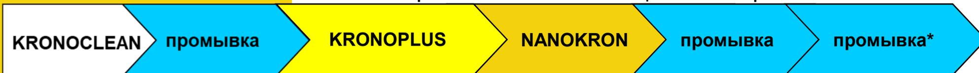
\* - на стадии финишной промывки рекомендуется использовать деминерализованную воду (данная рекомендация имеет общий характер и справедлива для всех типов подготовки поверхности, в том числе и традиционных).
